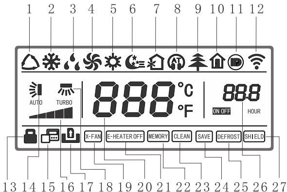
Obr. 2-2: LCD displej kabelového ovladače
