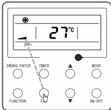
Obr. 3-6: Nastavení rychlosti ventilátoru
