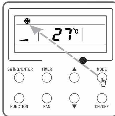
Obr. 3-4: Nastavení režimu provozu
