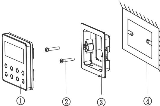
Obr. 1-2: Části kabelového ovladače
