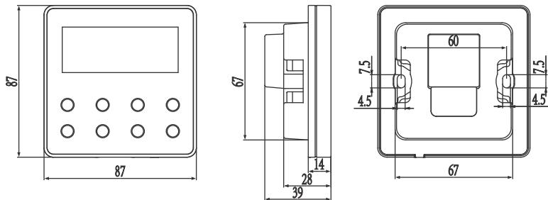
Obr. 1-1: Rozměry kabelového ovladače (v mm)
