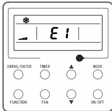
Obr. 4-1: Ochrana proti vysokému tlaku
