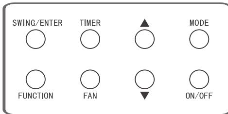
Obr. 3-1 Tlačítka kabelového ovladače
