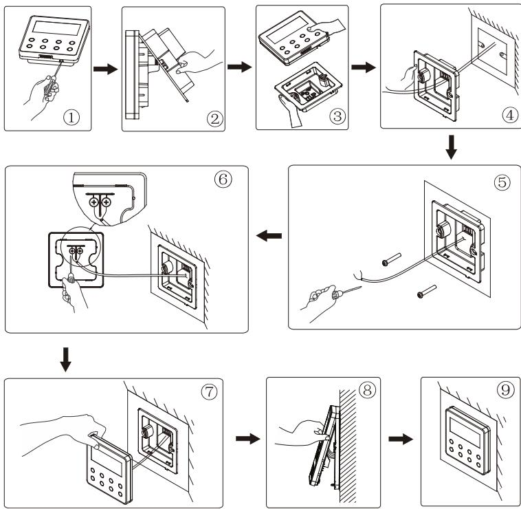
Obr. 1-3: Postup montáže kabelového ovladače
