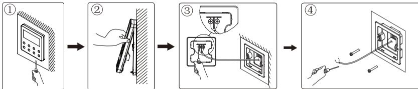
Obr. 1-4: Postup demontáže kabelového ovladače
