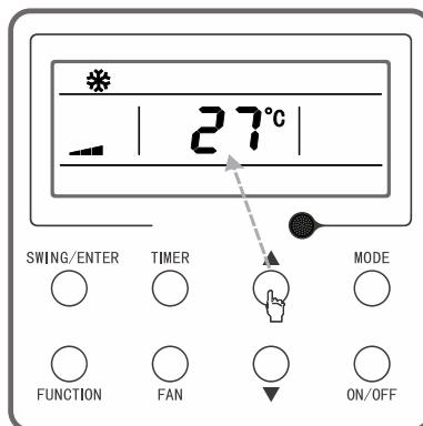
Obr. 3-5: Nastavení teploty
