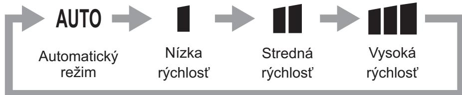
Rýchlosť otáčok ventilátora ostane zachovaná aj v prípade zmeny prevádzkového režimu, no počas prevádzky v režime Odvlhčovanie bude rýchlosť otáčok znížená na minimálnu. Túto rýchlosť nie je možné zmeniť, kým jednotka beží v režime Odvlhčovania.
