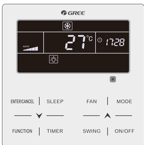
Zapnutá klimatizačná jednotka bez nastaveného časovača.
